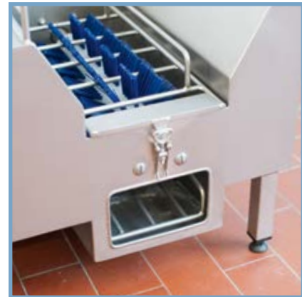
Getrennte Sohlen- und Oberschuhreinigung Separate cleaning of soles and uppers
